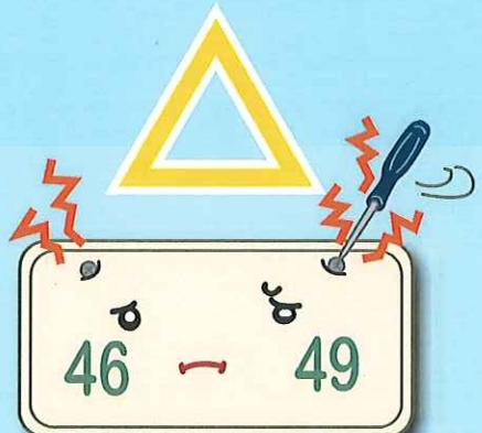
ナンバープレートを取り付ける際には、ネジを強く締め付けないようにご注意ください。
